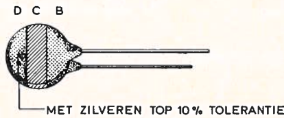
fig. 9. Kleurencode van NTC-weerstanden.
